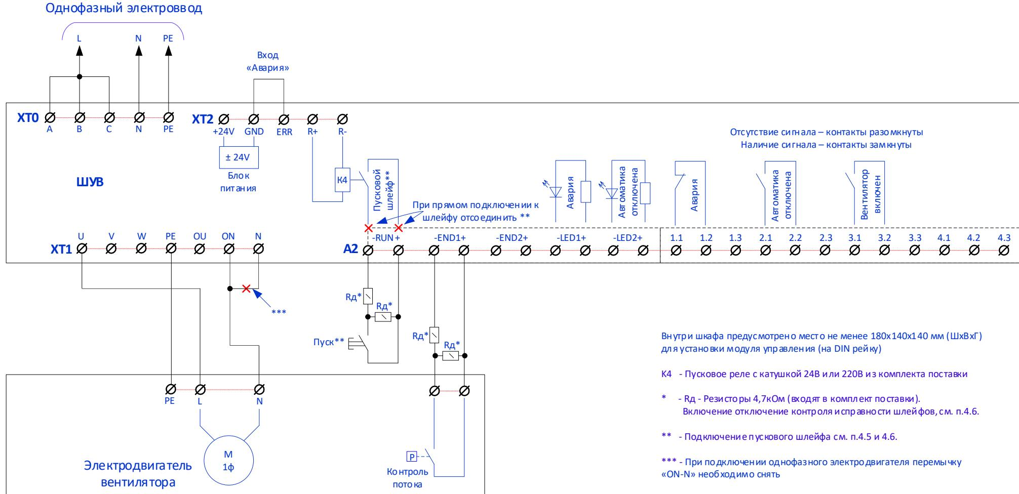
Схема подключения электрического воздухонагревателя для ШУВ+ТЭН:
